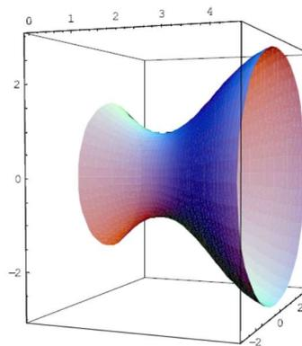
Soit  $f$ , une fonction positive et continue sur  $[a,b]$ . Le Volume  $V$  du solide généré par la révolution autour de l'axe  $(Ox)$  de la portion de courbe d'équation  $y = f(x)$  comprise entre  $x = a$  et  $x = b$  est obtenue par la formule :  $V = \pi \int_a^b (f(x))^2 dx$
